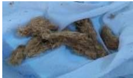
Gambar 2. Membran Selulosa dari Limbah Sabut Siwalan
